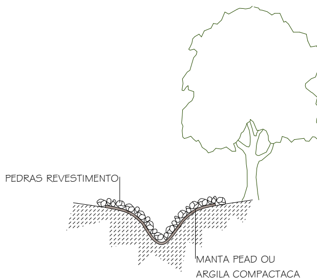
Figura 54: Corte esquemático de terreno e construção de canais de drenagem.
